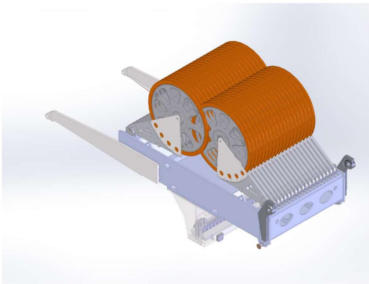
Fig.4 – Detalle del conjunto de poleas de tensado, sobre brazos articulados con cilindros tensores independientes
